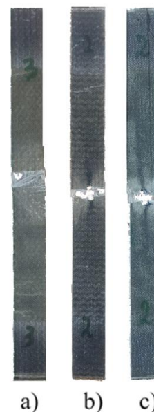
Рис. 7. Вид разрушенных образцов: а) – тип 1, б) – тип 2, с) – тип 3
