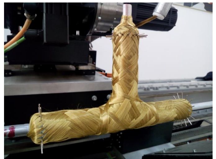
Рис. 7. Результат намотки изделия на станке с ЧПУ по рассчитанным траекториям укладки на поверхности тройника с круглым сечением
