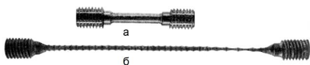
Рис. 1. Образец из титанового сплава ВТ3-1 с исходной неравномерностью диаметра поверхности рабочей части образца в виде кольцевых проточек: а – до деформации; б – после деформации в состоянии сверхпластичности [7]
