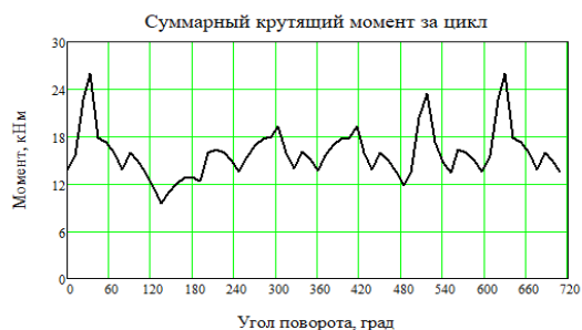
Рис. 16 Суммарный крутящий момент сопротивления ( M_c ) триплексного бурового насоса
