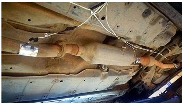
Рис. 1. Расположение термопар при измерении температуры элементов выпускной системы
