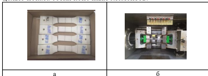
Рис. 2. Пластиковые образцы (а), использованные в эксперименте, и рабочая зона Gleeble 3800 с модулем Pocket Jaw (б)
