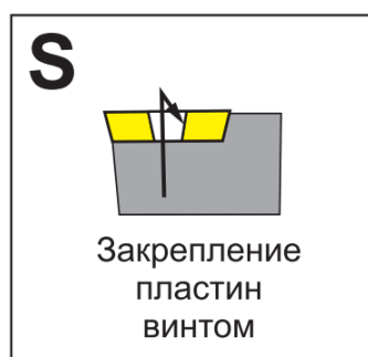
Рис. 11. Система крепления S. Закрепление пластин винтом
