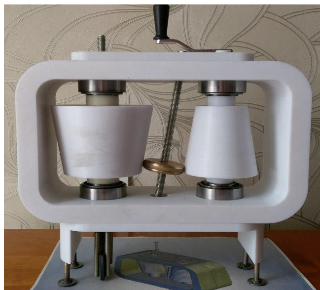
Рис. 7. Опытный образец фрикционного механизма привода затвора
