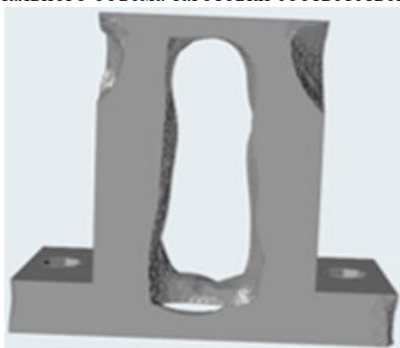
Рис. 8. Конструкция на этапе топологической оптимизации 50% остаточного объема материала
