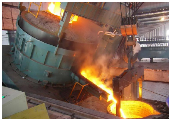
Рис. 1. Дуговая сталеплавильная печь вместимостью 6 тонн металла
