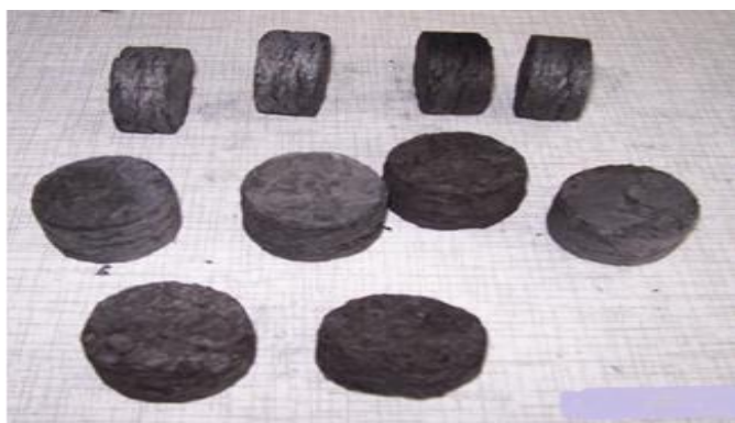
Рис.4. Пиролизованные брикеты из отходов сухой окорки лиственницы
