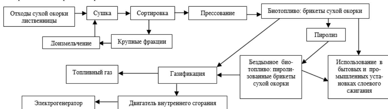
Рис. 5. Энергетическое использование брикетированных отходов сухой окорки лиственницы сибирской
