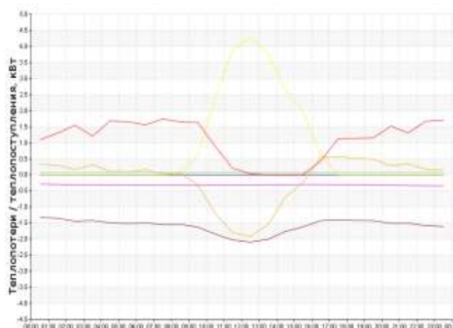
Рис. 4. Составляющие теплового баланса помещения в течение суток (графическое представление)
