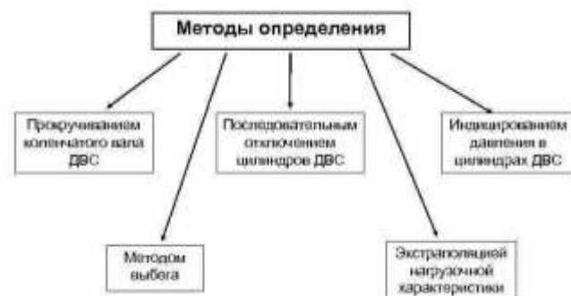
Рис. 2. Методы определения характеристик мощности механических потерь ДВС
