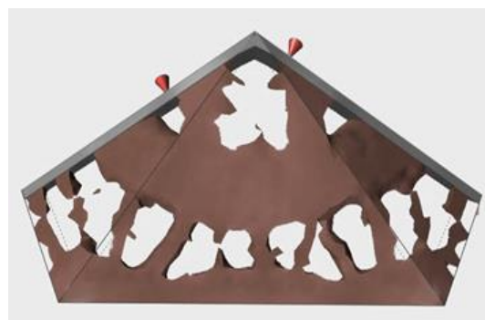
Рис. 3. Конструкции после топологической оптимизации при 85% от первоначального объема материала
