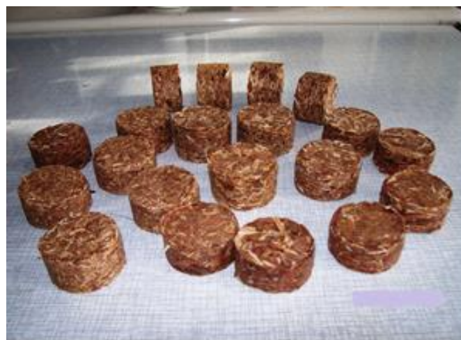
Рис. 2. Брикеты из отходов сухой окорки лиственницы
