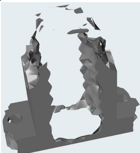
Рис. 10. Конструкция на этапе топологической оптимизации 20% остаточного объема материала
