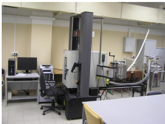
Рис. 1. Испытательная машина INSTRON 5982 с климатической камерой Instron-SFT 3119
