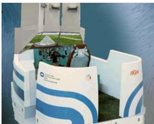
Рис. 2. Внешний вид пилотажного тренажёра лётчика без подвижности с трёхканальным устройством безочкового моделирования трёхмерного визуально наблюдаемого пространства для одного лётчика
