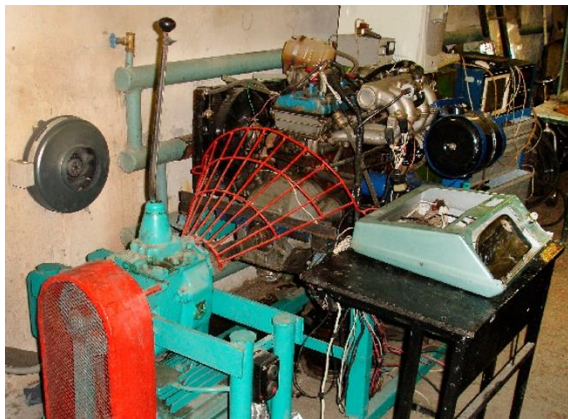
Рис. 1. Исследовательский стенд для испытаний систем двигателя ЗМЗ-4062 (а) и разработанное устройство – «электронно-управляемая нагрузка» двигателя (б)
