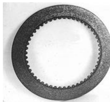
Рис. 4. Фрикционный диск с молибденовым газотермическим покрытием Ø176 мм толщиной 3,3 мм в состоянии перед эксплуатацией
