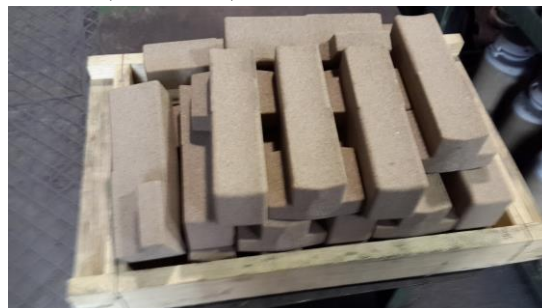
Рис 2. Стержни для производства фасонного чугуна, полученные по продувочной технологии из песчано-лигносульфонатной смеси
