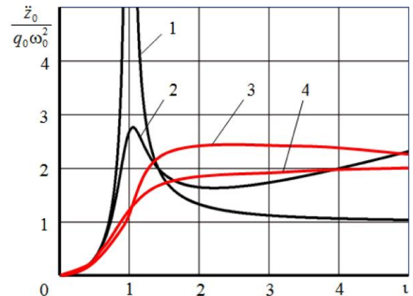
Рис. 8. Амплитудно-частотные характеристики ускорений систем: 1 – без демпфирования; 2 – с постоянным демпфированием; 3 – с демпфированием, изменяемым по закону 4 (рис. 7) без оптимального регулирования; 4 – при оптимальном управлении демпфированием
