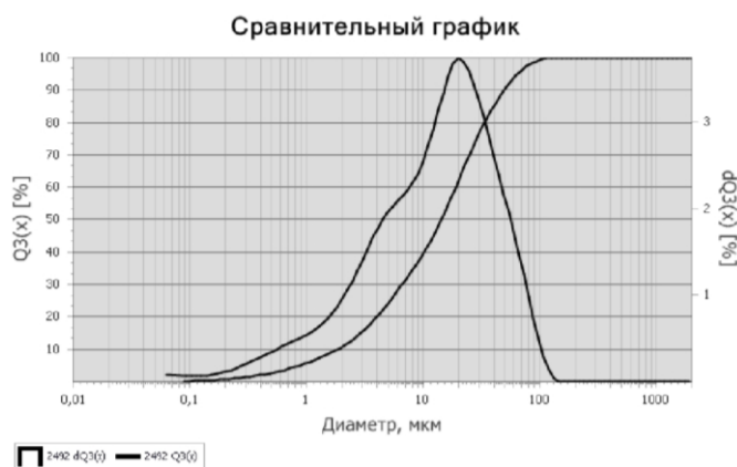
Рис. 2. Дифференциальная и интегральная кривые гранулометрического состава смеси лунного грунта-аналога ЛГА-3
