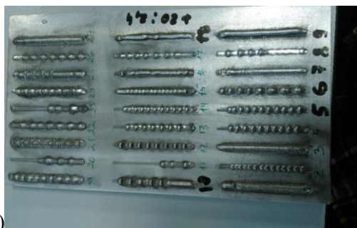
Рис. 1. Внешний вид валиков а) при лазерном выращивании при наложении одного слоя при диаметре пятна лазера 2,4мм (ряд валиков слева – различное соотношение скорости наплавки и подачи проволоки при Рл =6кВт, по центру Рл =4,5кВт, справа – Рл =3кВт б) при лазерно-дуговом выращивании изменение внешнего вида валиков при наложении одного слоя при различных диаметрах пятна лазера
