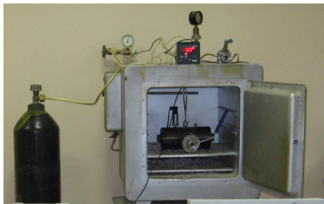
Рис. 3. Общий вид стенда для ресурсных испытаний неподвижных радиальных кольцевых уплотнений
