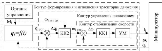
Рис. 4. Функциональная схема системы управления с контуром формирования траектории
