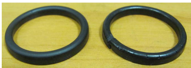
Рис. 6. Внешний вид уплотнений после испытаний: справа – в воздухе; слева – в азоте
