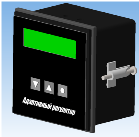
Рис. 6. Внешний вид адаптивного регулятора, разработанный в КОМПАС-3D
