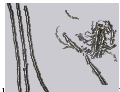
Рис. 4. Характерный вид стружки образующейся при фрезеровании титана ВТ20 твердосплавным инструментом ВК10ХОМ при использовании СОТС: 1 – обработка СОТС (ЭГТ); 2 – обработка СОТС (“активированная газовая среда”)
