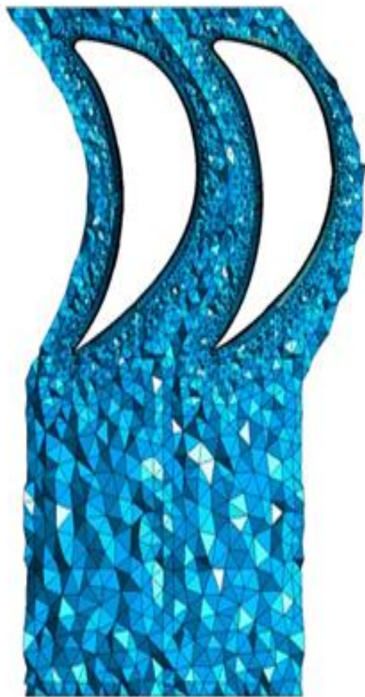
Рис. 3. Визуализация расчетной сетки по среднему сечению рабочего колеса
