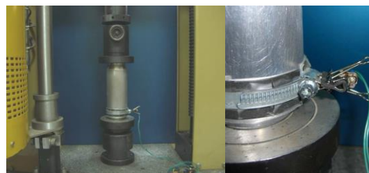
Рис. 3. Осевое сжатие с приложением вынужденных колебаний
