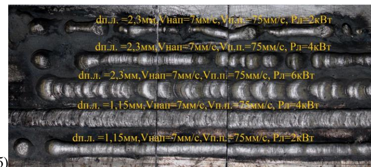
Рис. 1. Внешний вид валиков а) при лазерном выращивании при наложении одного слоя при диаметре пятна лазера 2,4мм (ряд валиков слева – различное соотношение скорости наплавки и подачи проволоки при Рл =6кВт, по центру Рл =4,5кВт, справа – Рл =3кВт б) при лазерно-дуговом выращивании изменение внешнего вида валиков при наложении одного слоя при различных диаметрах пятна лазера
