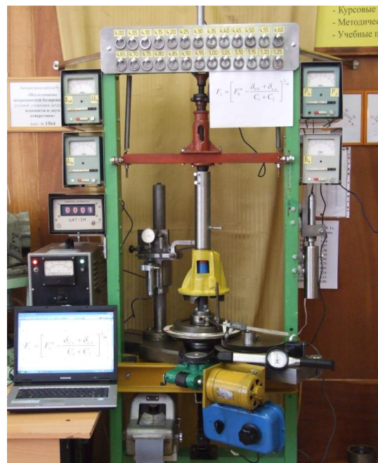
Рис. 8. Экспериментальная технологическая установка для регулирования преднатяга дуплексируемых подшипников с адаптивным управлением процессом измерения размера требуемого дистанционного комплекта (распорная втулка – компенсатор) с варьированием технологической силы на подшипники
