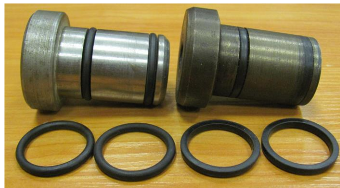
Рис. 5. Внешний вид пробки: слева - до испытаний; справа – после испытаний
