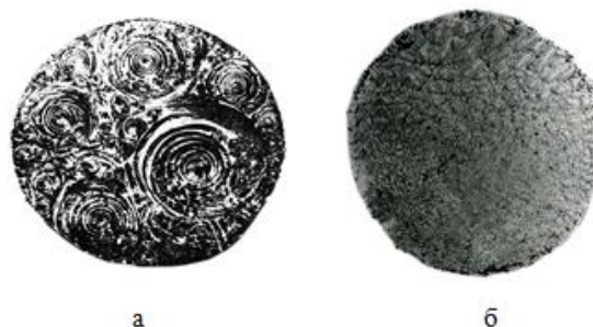
Рис. 2. Кристаллиты, образовавшиеся при охлаждении расплавленного пека на поверхности металла
