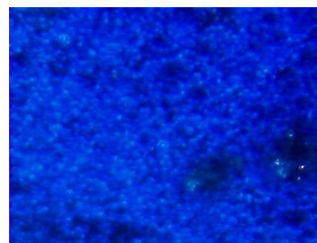
Рис. 2. Эмалевое покрытие, полученное по технологии 2С/1F
