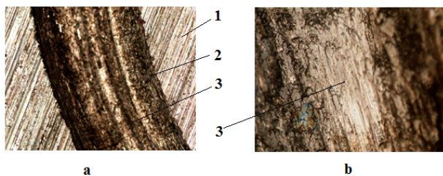
Рис. 5. Характер износа неупрочненных образцов: а – канавка (увеличение \times 5 ); б – дно канавки (увеличение \times 20 ); 1 – поверхность образца, 2 – канавка износа, 3 – дно канавки износа)
