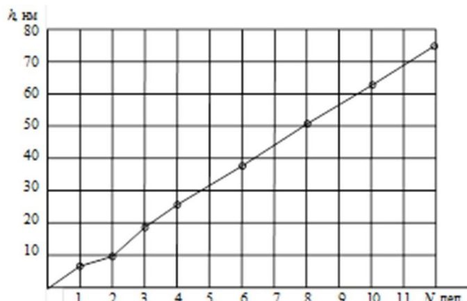
Рис. 4. График для определения толщины напыляемой плёнки h по показаниям N индикаторного прибора
